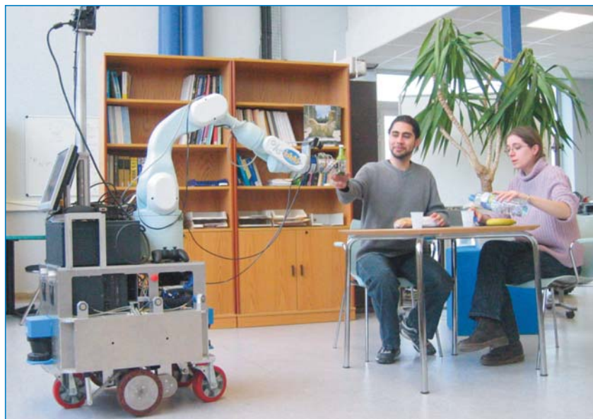
Fig 1 : Les chercheurs du LAAS travaillent dans le cadre de projets européens comme Cogniron, Dexmart ou Chris au développement de robots personnels capable d'interagir avec les humains. Pour cela les chercheurs étudient comment les robots perçoivent les humains et leurs attitudes, comment ils les modélisent et comprennent leurs gestes, comment les approcher d'une manière adéquate, comme leur tendre un objet etc..
