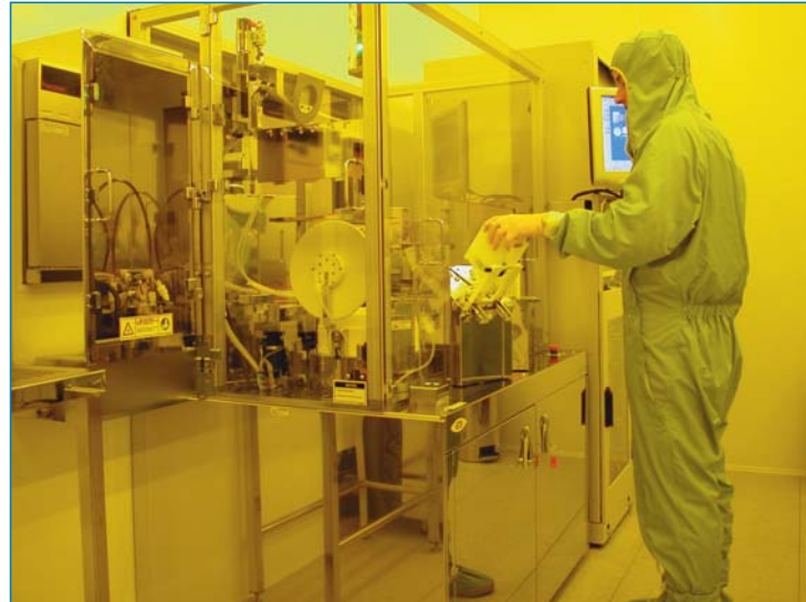
Fig 2 : Centrale de technologie du réseau RTB : Système d'enduction/développement automatisé de résines photosensibles pour la réalisation de micro et nano composants.
