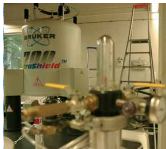
Spectrographe RMN «blindé» 700 Mhz, premier équipement acheté pour le CeRMN
